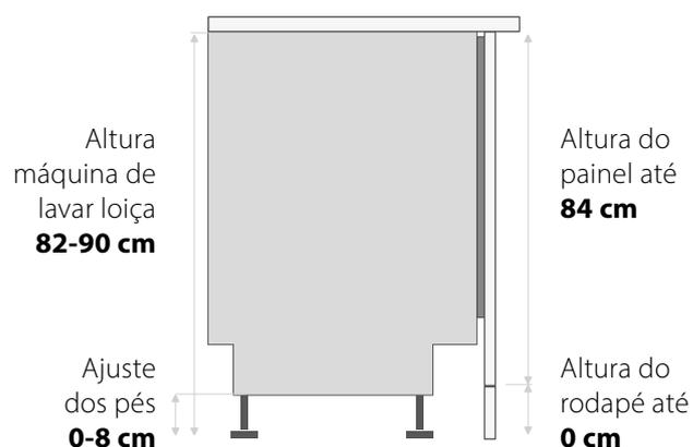
A nova máquina de lavar loiça com dobradiças deslizantes que lhe **permitem sustentar painéis de diferentes materiais com um peso de 3 kg a 10 kg e com 16 mm a 25 mm de espessura.**
